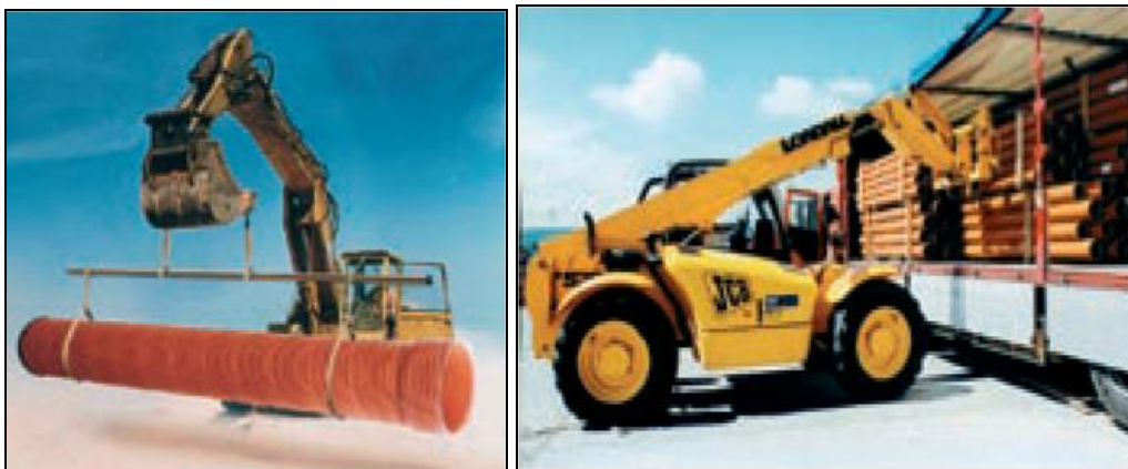
2 paveikslas. Mechanizuotas vamzdžių krovimas.
